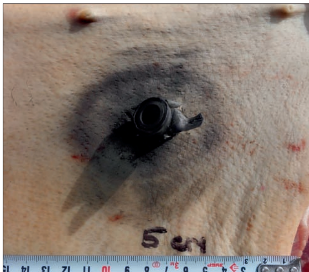
Рис. 2. Повреждение биологического имитатора (фрагмент груди свиньи), причиненное выстрелом из травматического пистолета МР-341 «Хауда» с расстояния 5 см Fig. 2. Damage to a biological simulator (a fragment of the chest of a pig) caused by a shot from a traumatic pistol MR-341 "Howdah" from a distance of 5 cm
